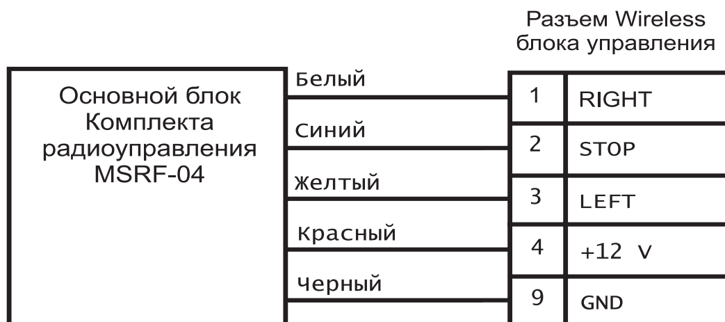
Рисунок 4 - Схема подключения комплекта радиуправления MSRF-04
